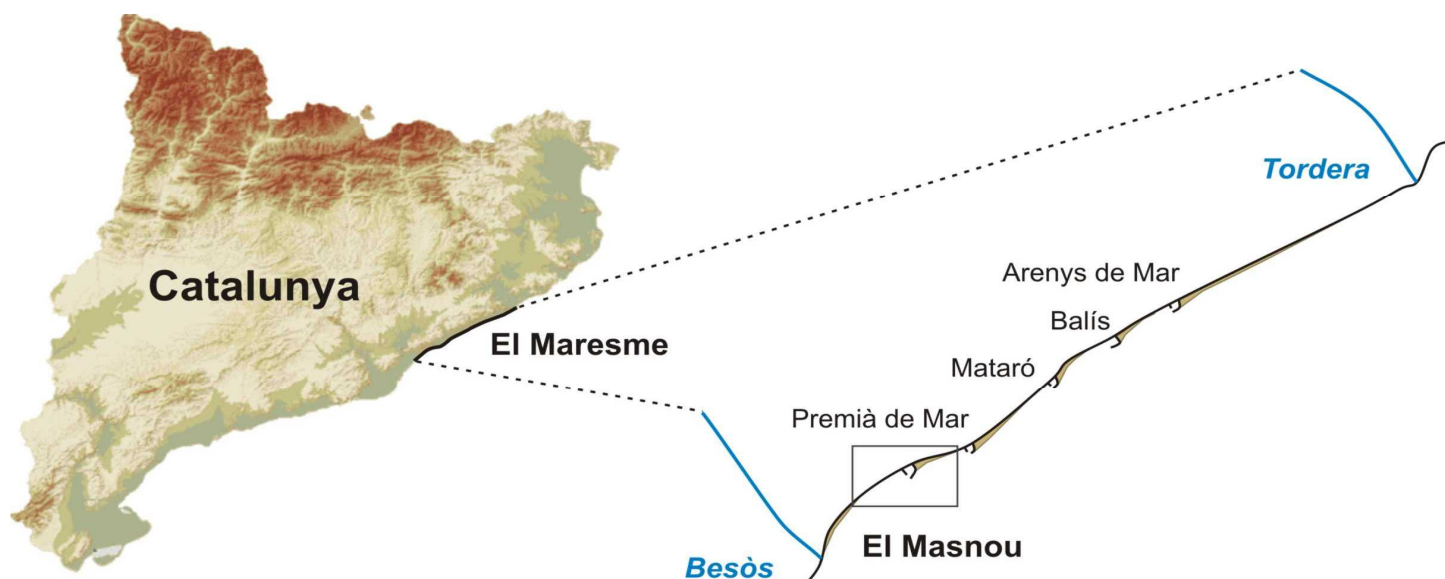
Figura 22. Cel·la litoral del Maresme. Localització al territori català i segmentació artificial en sis cel·les litorals per a la construcció de cinc ports esportius (Arenys de Mar, Balís, Mataró, Premià de Mar i el Masnou).
